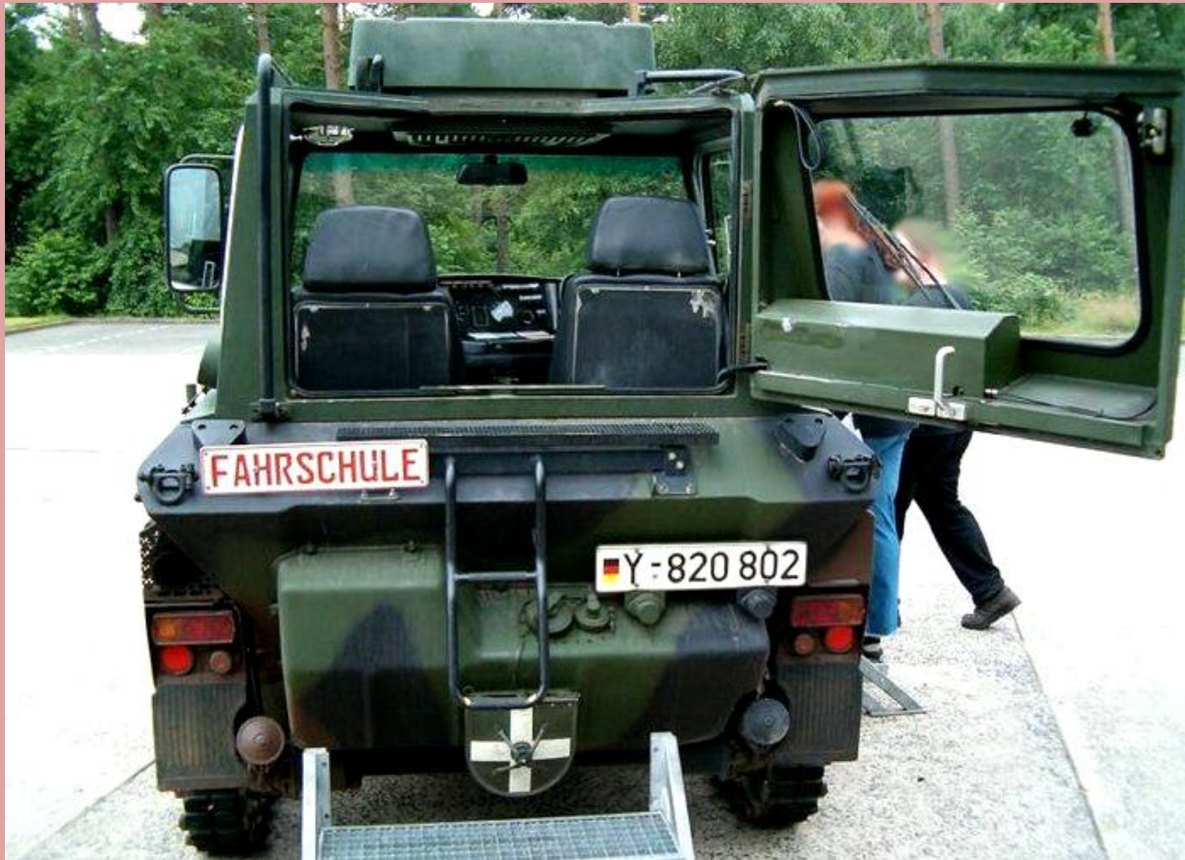
Heckansicht auf die Kabine, sie bietet Platz für den Fahrlehrer und eine weitere Person.
