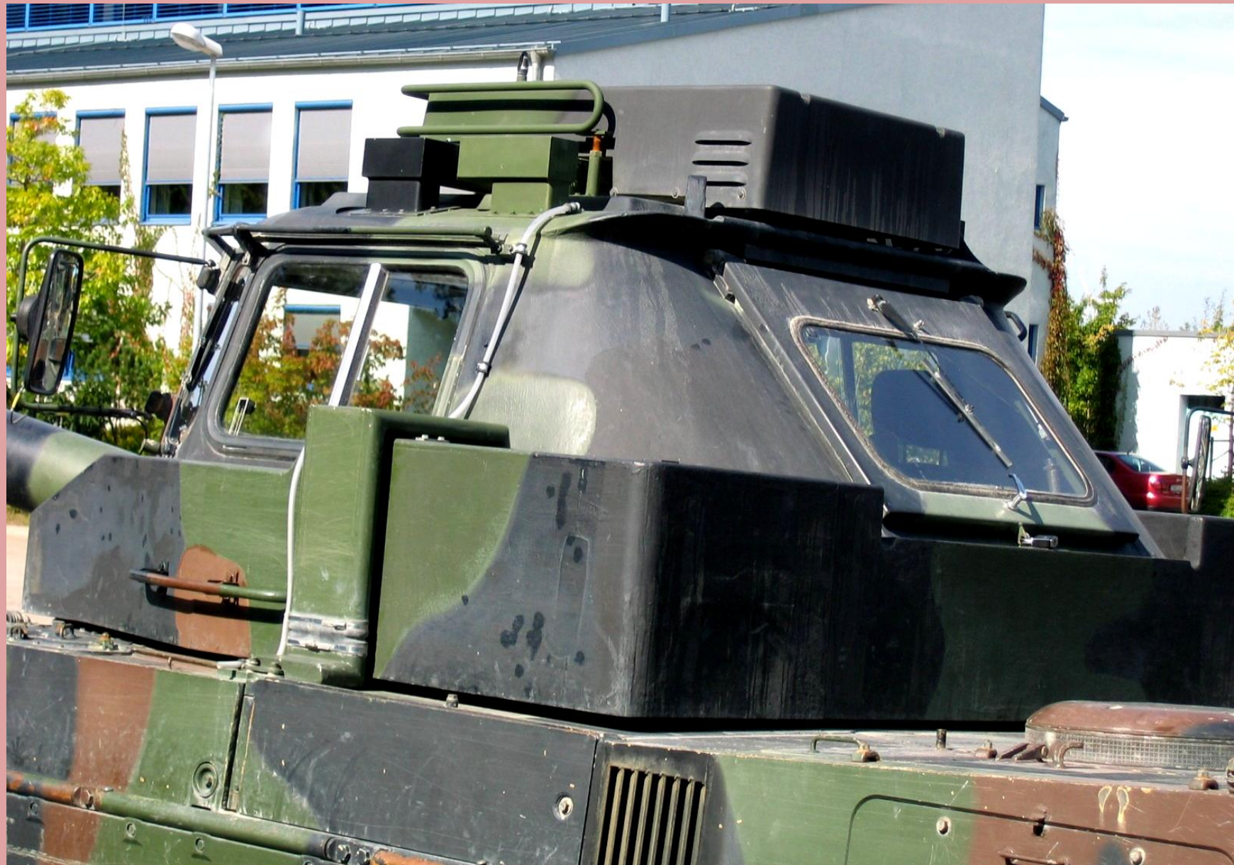
Die Fahrschulkabine des Fahrschulpanzers Leopard 2A4.
