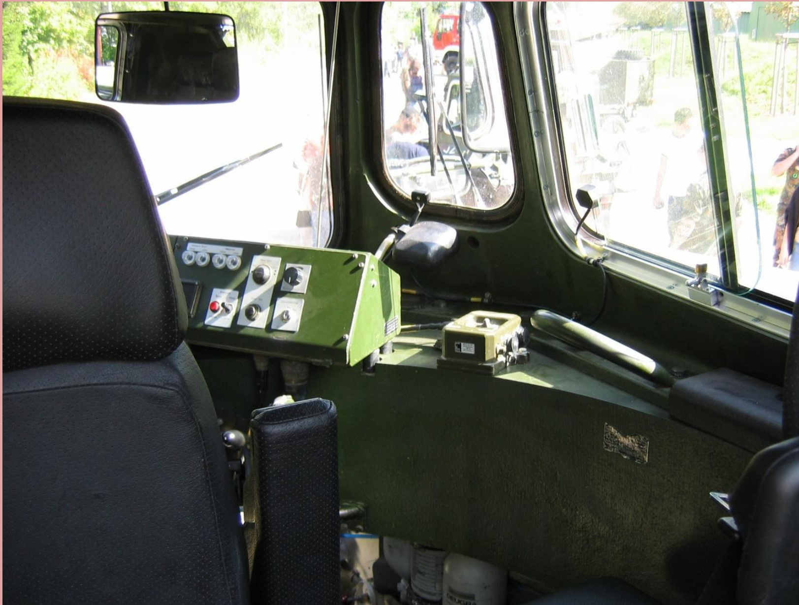
Rechte Seite des Fahrlehrerplatzes im Fahrschulpanzer Leopard 2A4.
